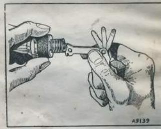
Användning av Champions speciella mät- och justeringsverktyg. Böj sidoelektroden, aldrig mittelelektroden.
