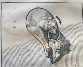
Tryck ned låknappen för att öppna bagageluckan. När luckan är stängd kan den läsas med medföljande nyckel.
